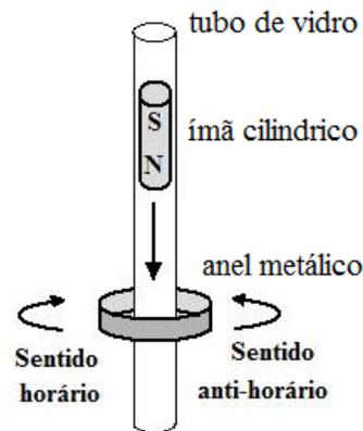
O ímã ao atravessar verticalmente todo o tubo com o polo norte voltado para baixo, provoca uma corrente elétrica induzida no anel. Na figura são indicados os sentidos horário e anti-horário possíveis para a corrente induzida.
