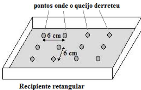
Supondo isso ser efeito do fenômeno da formação de ondas estacionárias entre as paredes do forno e que a velocidade de propagação das ondas eletromagnéticas no ar seja  $3 \times 10^8$  m/s, o jovem calculou a frequência utilizada no gerador de microondas desse forno. Assinale a alternativa que apresenta corretamente esse valor.
